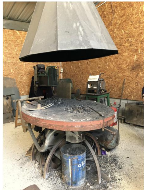
La forge centrale permet de restaurer et de produire les éléments de décor.
